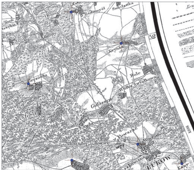
Ryc. 4. Deformacja fragmentu mapy Kwatermistrzostwa z lat 1822–1843 po nadaniu georeferencji w odwzorowaniu Bonne'a
